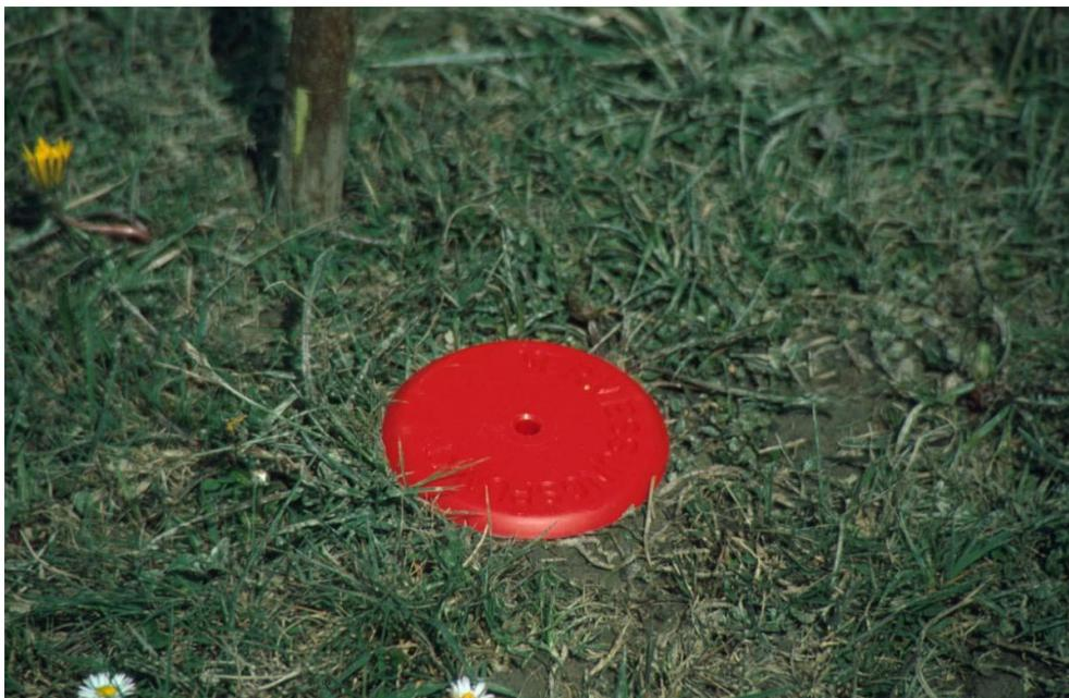
**Abbildung 20:** Die Eckpunkte der Probeflächen wurden mit 30cm langen Stahlrohren markiert, die am oberen Ende eine Kunststoffmarke mit der Aufschrift „Vermessungspunkt“ tragen
