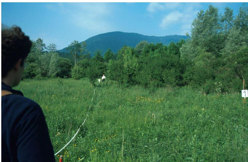
**Abbildung 18:** Die Vermessung der Flächen erfolgt im Gelände durch Maßband und Bussole, Foto: Kirchmeir
