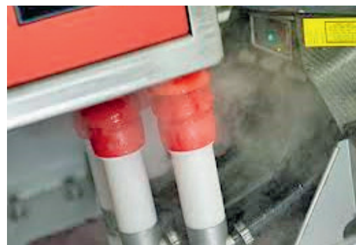
Foto 20: Zwischendesinfektionsanlage mit Heißdampf.
