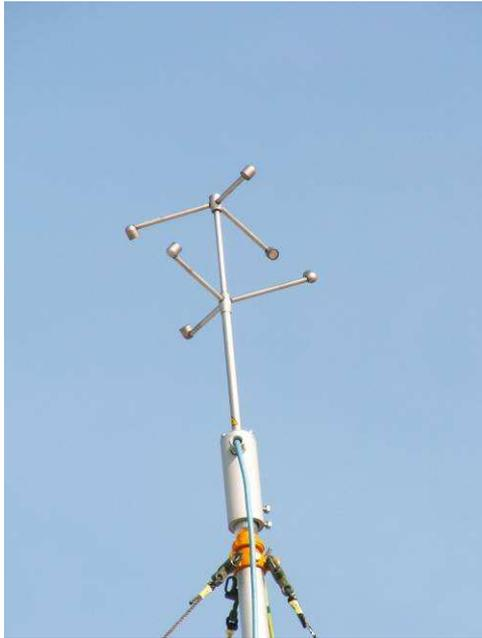
Abbildung 6: Messkopf des dreidimensionalen Ultraschallanemometers.
