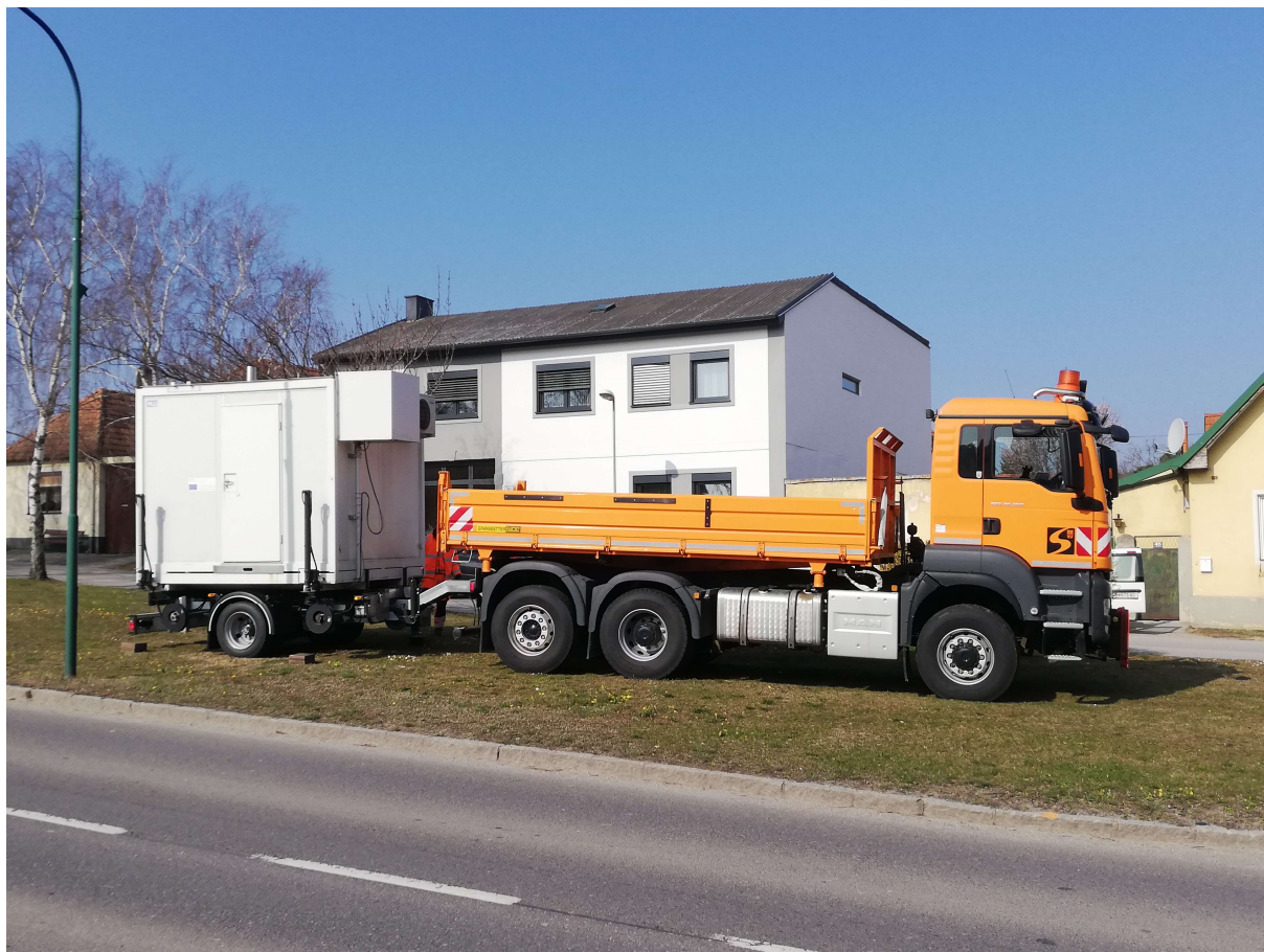
Abbildung 6: LKW mit Anhänger und mobilem Messcontainer.
