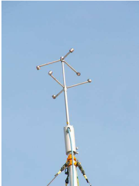
Abbildung 6: Messkopf des dreidimensionalen Ultraschallanemometers.
