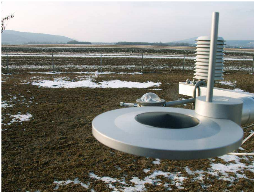
Abbildung 5: Strahlungsbilanzgeber von Kipp & Zonen (Vordergrund) und Schenk (Hintergrund, mit Kunststoffglocke). Beide Geber sind ungefähr gleich groß, die Verzerrung ist durch die Optik des Photos bedingt).
