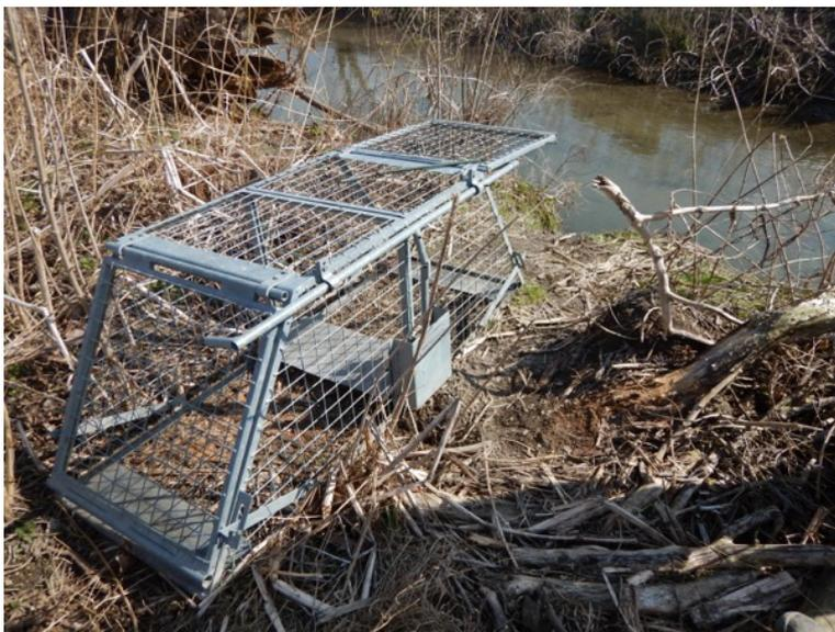
Abbildung 7: Kastenfalle für den Lebendfang (mit Kellenschutz)
