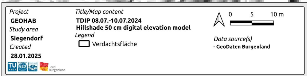
Abbildung 49. Die Schummerung des digitalen Höhenmodells für die Untersuchungsfläche zeigt eine rechteckige Vertiefung, die als Verdachtsfläche identifiziert wurde.
