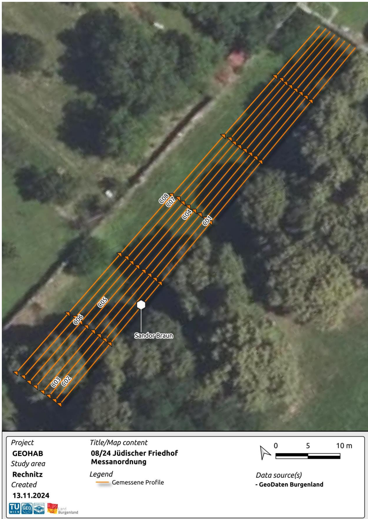
Abbildung 39. Untersuchung einer der beiden Freiflächen auf dem jüdischen Friedhof von Rechnitz mittels der IP-Methode, mit dem Ziel etwaige existierende Gräber zu identifizieren und zu lokalisieren.
