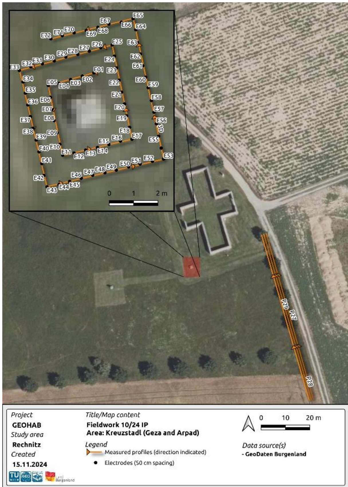
Abbildung 25. Detaillierte Untersuchung mit der IP-Methode in Bereichen, die von der Taskforce Rechnitz als mögliche Grablegen der Brüder Geza und Arpad identifiziert und als Verdachtsflächen definiert wurden.
