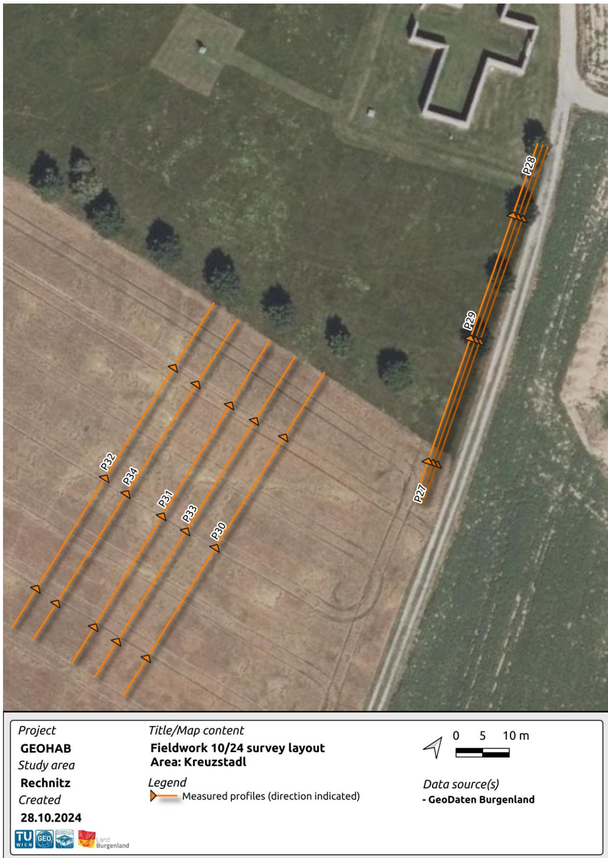
Abbildung 26. Detaillierte Untersuchung mit der IP-Methode in Bereichen, die von der Taskforce Rechnitz als relevant für die Untersuchung der in mehreren Luftbildern sichtbaren linearen Strukturen.
