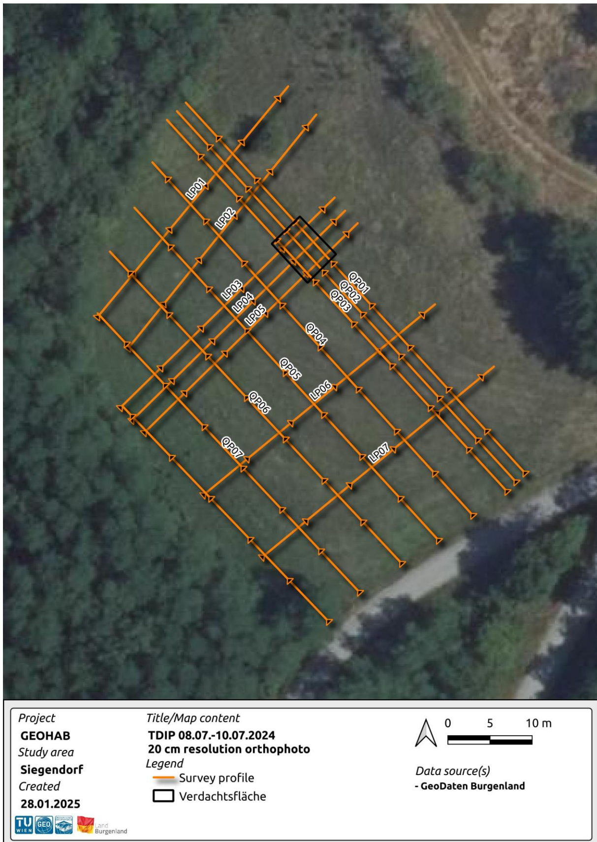
Abbildung 50. Die Profile für die geophysikalischen Untersuchungen wurden basierend auf der Position der Verdachtsfläche ausgewählt.
