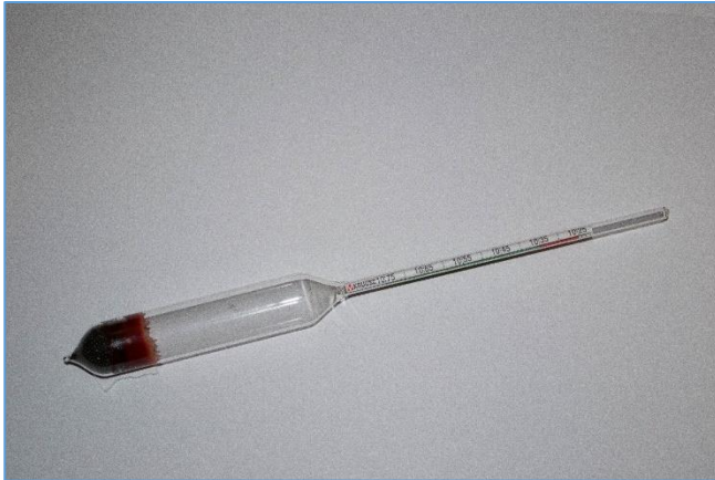
Bild 2+3: Kolostrometer bzw. Senkspindel zur Bestimmung der Dichte.
