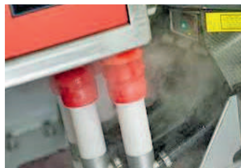
Foto 20: Zwischendesinfektionsanlage mit Heißdampf.
