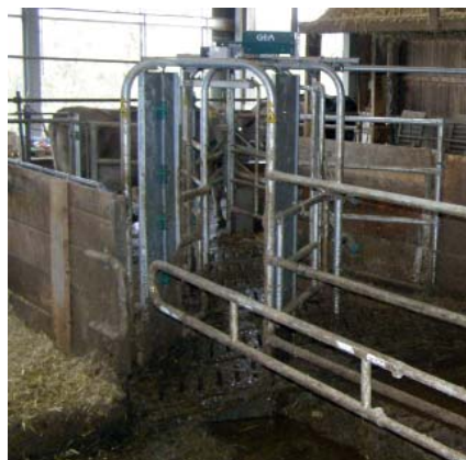
Bild 10: Vorselektion der Kühe mit Melkanrecht über ein 3-Wegetor in den Warteraum.
