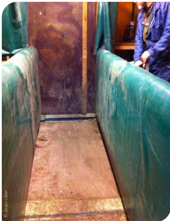
Abb 34 Zwangsstand mit hydraulischen Wänden und Boden
