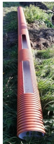
Abbildung 11: Verstopfter Rohreinlauf einer Dammdrainage; Rohreinlauf mit Schlitzten (Foto: P.Larch /Mitte, B. Schütz /rechts)
