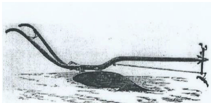
Abb. 8: Häufelpflug, diesen konnte man beim Eisenhändler Antal Fromm bestellen. Aus: Borászati Füzetek (Hefte für Weinkunde), 1872, S. 640.
