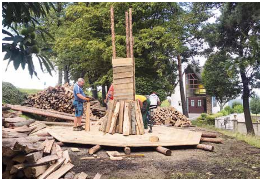
■ oben: Gewusst, wie – der Aufbau eines Kohlenmeilers
