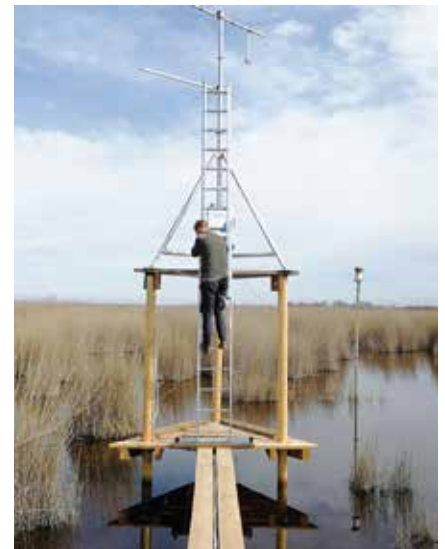
■ Methanmessturm des Kooperationspartners Universität Wien bei der Biologischen Station – eine von sechs Anlagen in Österreich im Rahmen des Infrastrukturprojekts LTER-CWN
